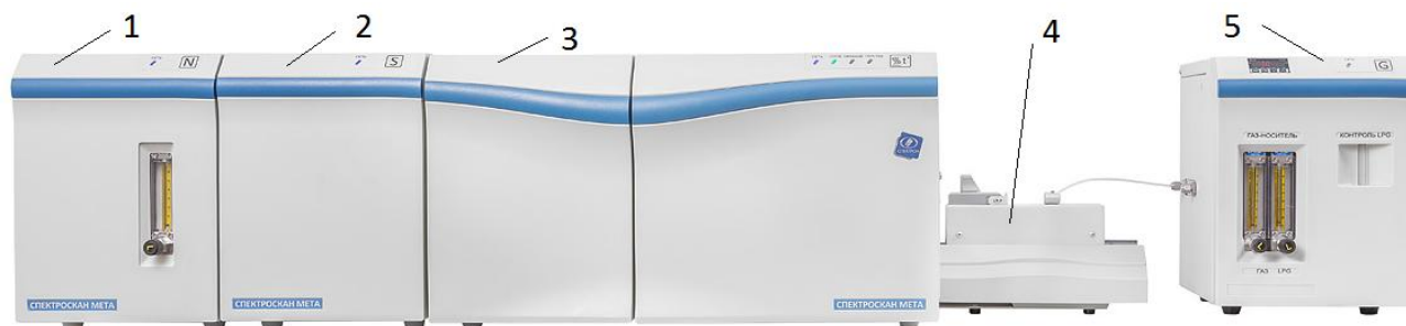
Рисунок 1 – Общий вид анализатора: 1) блок измерения азота; 2) блок измерения серы; 3) блок печи; 4) модуль ввода жидких проб; 5) модуль ввода газов с каналами ввода газа и сжиженного газа
