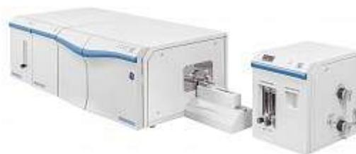
Анализатор позволяет определять содержание серы и азота в нефти и нефтепродуктах (дизельное топливо, бензин, керосин, газойль и любые дистиллятные нефтепродукты), углеводородном газе, сжиженном углеводородном газе (СУГ), природном газе, сжиженном природном газе (СПГ), продуктах химического синтеза, биологических материалах методами ультрафиолетовой флуоресценции и хемилюминисценции.
