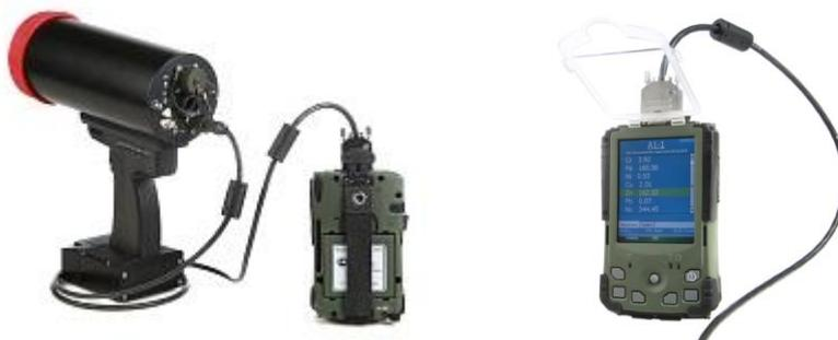
Портативный рентгенофлуоресцентный энергодисперсионный СПЕКТРОМЕТР.
