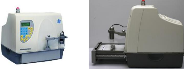
Спектрометр на базе СПЕКТРОСКАН МАКС-GF1(2)Е с протяженной пробозагрузкой и возможностью локального анализа для проведения различных экспертиз
